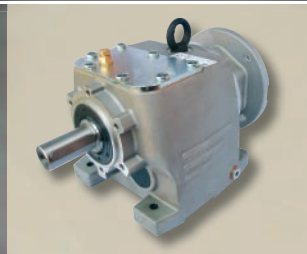
↑ MTC..A – čelní převodovky MTC..A – коаксиальные редукторы Velikost/Размер 0 – 8 P_1 = 0,12 – 30 \text{ kW/kBm} M_k 20 – 3000 \text{ Nm/Hm}
