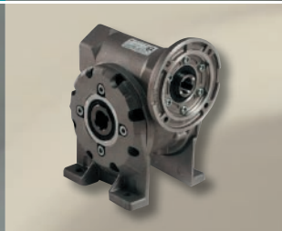
↑ RT/MRT..A – šnekové převodovky RT/MRT..A – червячные редукторы Velikost/Размер 30 – 180 P_1 = 0,09 – 15 \text{ kW/kBm} M_k 5 – 2540 \text{ Nm/Hm}
